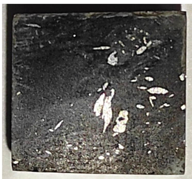
Структура руды до разрушения (поле 14x14 мм)
